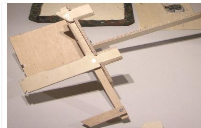
Querträger einstecken sowie die Führungshaken einstecken dann Mausbrettträger anschrauben
